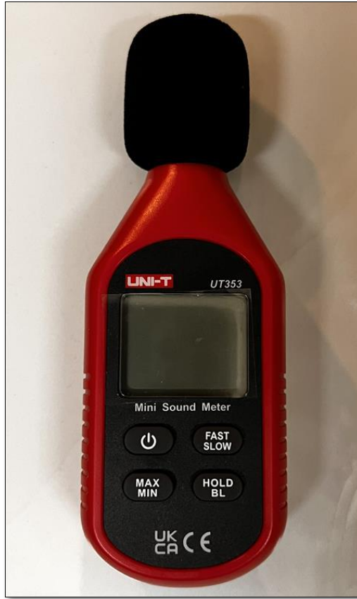
شكل رقم (2) جهاز Sound Level Meter المستخدم في القياس، المصدر: من تصوير الباحثان، 2025م
